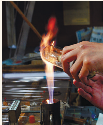
ガラス管を加工する工程。 手仕事で顧客ニーズをつかむ。
